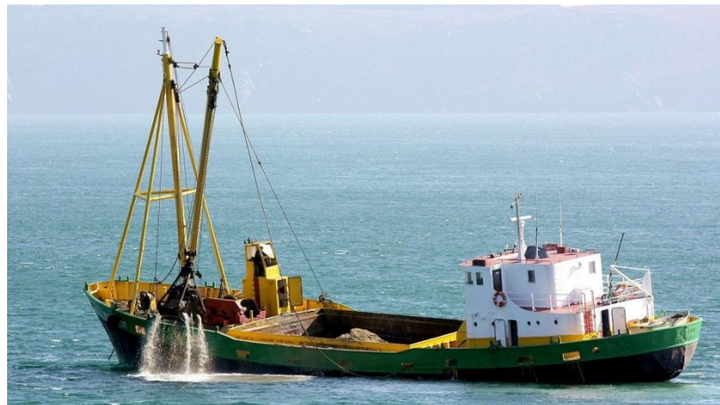
Figure 16 - Drague à benne preneuse au large de Brest
