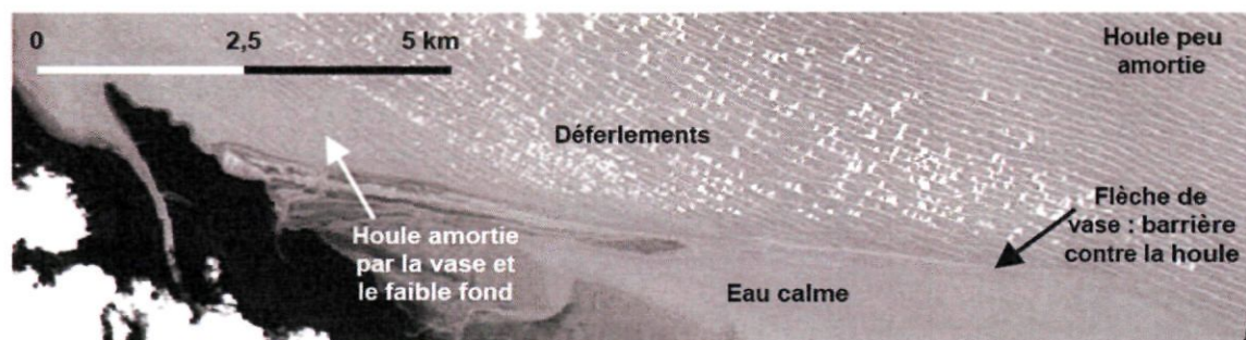
Figure 19 - Propagation de la houle dans la région de Kaw observée sur l'image SPOT du 14/12/2001 bande XS1 (d'après Baghdadi et al., 2005)
