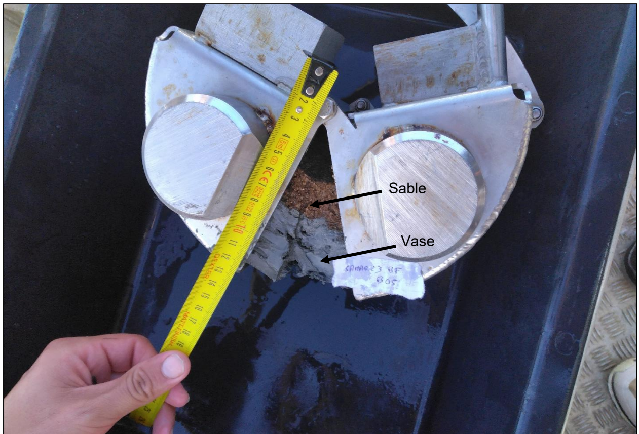
Figure 14 : Benne Van Veen avec les sédiments prélevés encore en place à l'intérieur (avec le sable en haut et la vase grise en bas).
