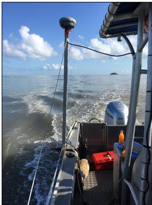
Figure 13 : Installation de la sonde mono-faisceau double-fréquences couplée au DGPS-RTK avec le système de correction TERIA.
